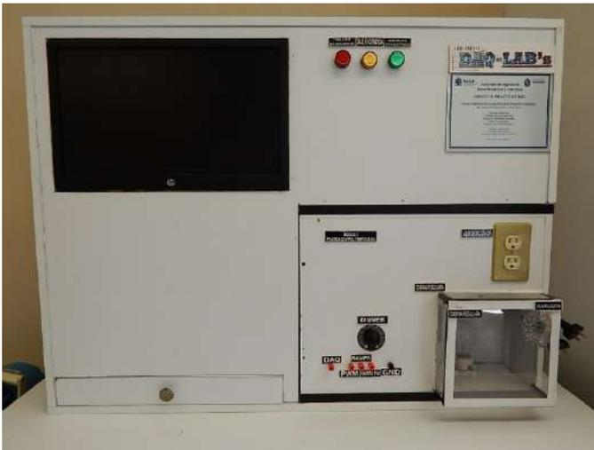
CONSOLA DE PRUEBAS CON SISTEMA DE ADQUISICIÓN DE DATOS (LAB VIEW), PARA CABINA DE PRUEBAS DE MOTORES (MAGNITUD DE TEMPERATURA)
