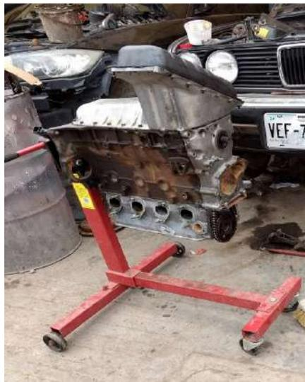
**Figura 1 – Soporte de motor en uso.**
