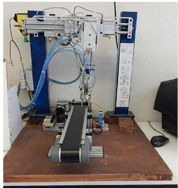
BANDA TRANSPORTADORA AUTOMÁTICA, CONTROLADA POR UN PLC (CONTROLADOR LÓGICO PROGRAMABLE) GRADO INDUSTRIAL.
