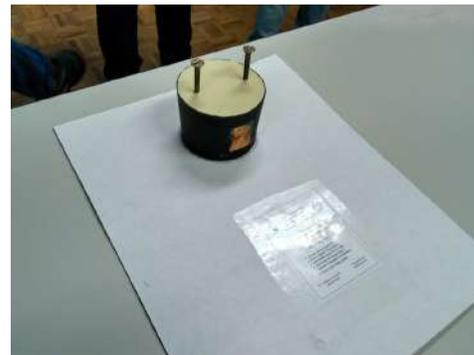
**Figura 4. Otro prototipo de capacitor; se observa que tiene terminales de tipo tornillo**
