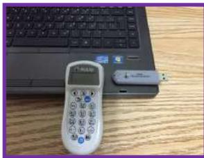
**Figura 1.** Fotografía de los controles inalámbricos (votadores) que usan los estudiantes para contestar preguntas presentadas en clase. Las respuestas se reciben en la computadora mediante una antena receptora conectada a un puerto USB. Los resultados se grafican de manera inmediata.
